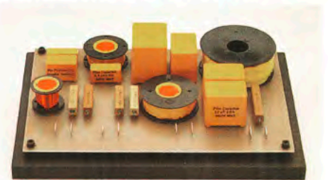
Die fein abgestimmte und erfolgreich getestete Frequenzweiche
